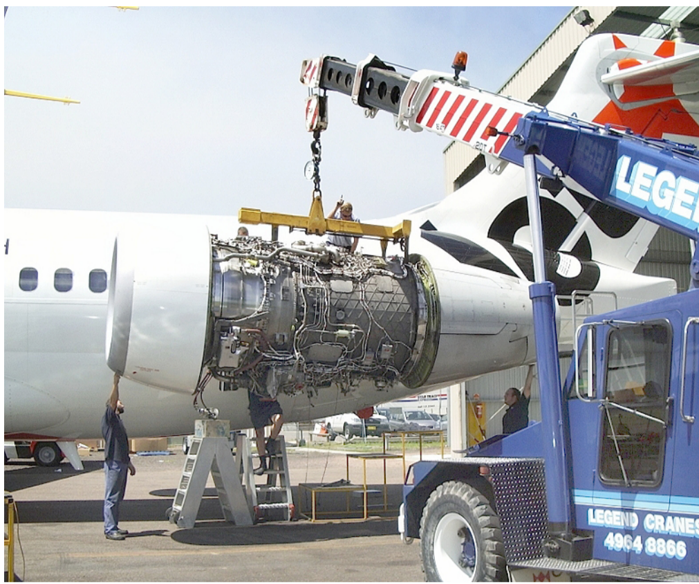
Legend Cranes ist der erste australische Kunde des Coburger Unternehmens. Hier ist ein Kran in „Down Under“ im Einsatz beim Auswechseln einer Flugzeugturbine.
