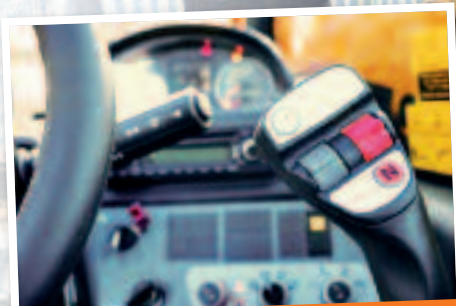
Ventil Control Plus: Der Nutzer steuert über einen hydraulischen Joystick die Arbeitshydraulik des Kranarms.
