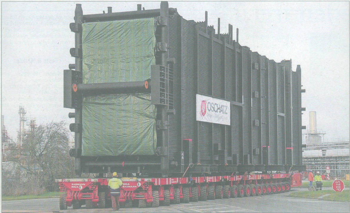
33 Meter lang, 330 Tonnen schwer: Die in Bonn ansässige Firma Baumann Schwertransporte gehört zu den Kunden der Matusch GmbH. Auch der Transport dieses riesigen Wärmetauschers wurde mit der E.P.O.S.-Software aus Coburg abgewickelt. Foto: privat
