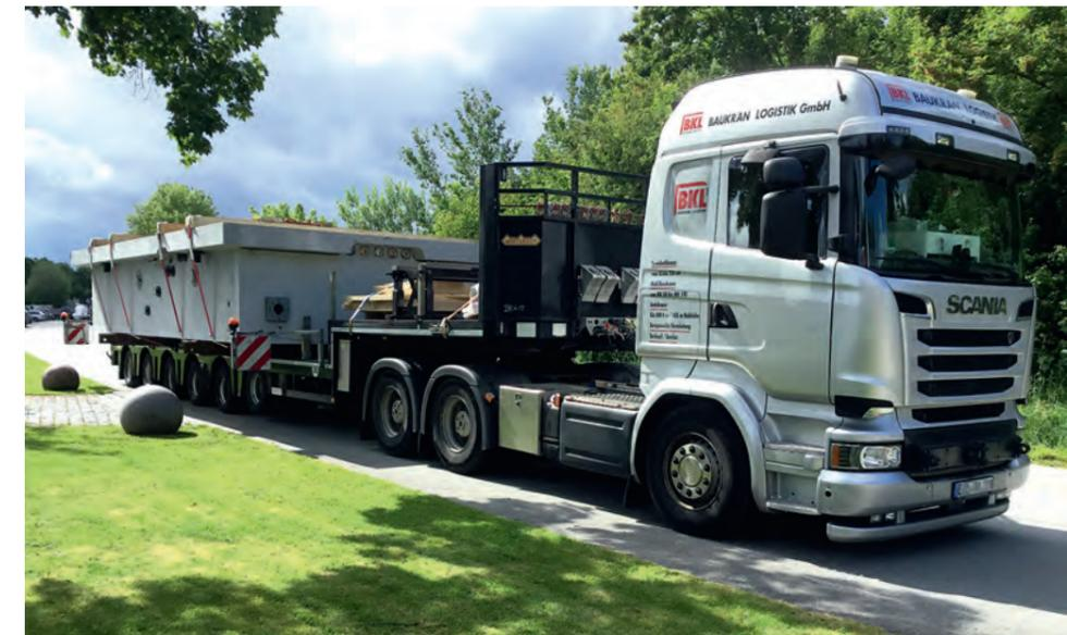
Ein Lkw mit 6-Achs-Semi-Tiefelader aus der BKL Flotte transportiert einen 21 t schweren Pool. Für den mit 4,60 m überbreiten Transport stellten die Kranspezialisten die BF3- und BF4-Begleitung.
